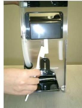
6. 管嘴先端的傳感器若有污垢，會導致錯誤動作，用牙刷和水洗淨除去污垢。
