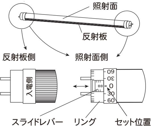
4. これから取り付ける LED 照明の角度調整ダイヤルが両端とも 0 (ゼロ) にセットされていることを確認してください。
