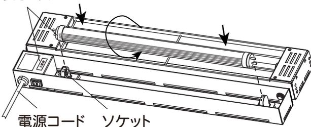
5. LED 照明は片側給電です。電源コード側のソケットに「入電側」と書いてある電極を差し込み、照射面が上にくるように 90° 回転させてください。
